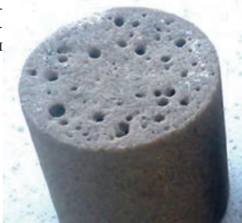
Рис. 2. Разветвленная система червоточин в коллекторе позволяет увеличить проницаемость ПЗП и дебит скважин
