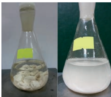
Рис. 7. Состав DSM-300 диспергирует отложения сульфата кальция, что позволяет их удалить простой промывкой
