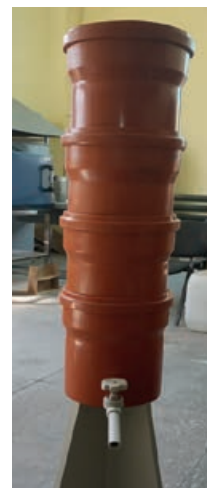
Рис.5. Пилотная установка очистки питьевой воды фильтрационного типа
