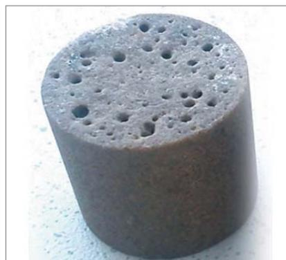
Рис. 2. Разветвленная система червоточин в коллекторе
